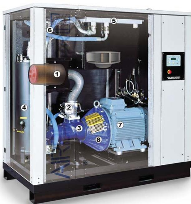
Винтовой компрессор всасывает атмосферный воздух через воздушный фильтр **1** со сменным фильтрующим элементом. Далее очищенный воздух проходит через многофункциональный регулятор всасывания **2** и попадает в винтовой блок **3**, являющийся «сердцем» компрессора. Здесь воздух сжимается и перемешивается с маслом, впрыскиваемым в блок в точно дозированном количестве. Образовавшаяся воздушно-масляная смесь нагнетается в сепаратор **4**, где происходит разделение масла и воздуха.
