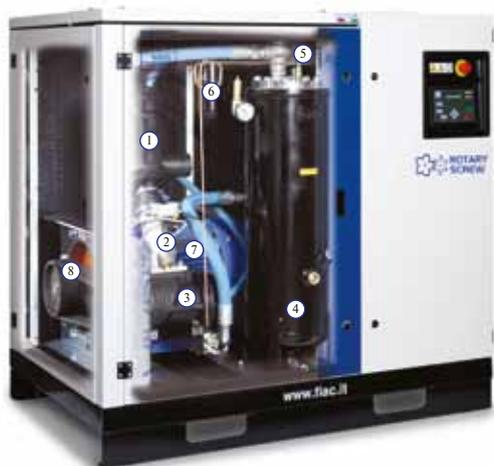
Компрессор всасывает атмосферный воздух через воздушный фильтр **1** со сменным фильтрующим элементом. Далее очищенный воздух проходит через регулятор всасывания **2** и попадает в винтовой блок **3**. Здесь он сжимается и перемешивается с маслом, впрыскиваемым в блок в точно дозированном количестве. Образовавшаяся воздушно-масляная смесь нагнетается в сепаратор **4**, где происходит разделение масла и воздуха.
