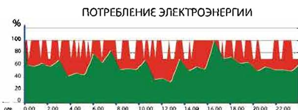
Обычный винтовой компрессор при достижении максимального рабочего давления переходит в режим холостого хода. Если потребление сжатого воздуха небольшое, то энергопотребление на холостом ходу становится избыточным.
