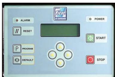
Микропроцессорная система управления FIAC CHECK CONTROL обеспечивает полный контроль всех рабочих параметров компрессора и позволяет интегрировать несколько машин в единую компрессорную сеть предприятия. Электронный дисплей со световой сигнализацией отображает основные рабочие параметры:
