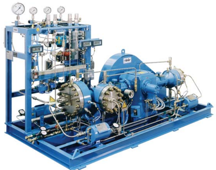
3-stufiger Membrankompressor mit digitaler Öldruckanzeige und Öldrucküberwachung. Modell: MKZ 280-10/185-20/120-100 für Heliumbetrieb Leistung: 20 Nm 3 /h (~12 scfm) Ansaugdruck: 8 bar (116 psi) Enddruck: 880 bar (12.760 psi)
