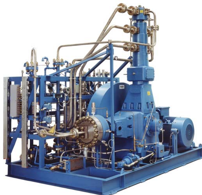
2-stufiger trockenlaufender Kolbenkompressor mit Membran-Endstufe Modell: 120TK500 / MKZ 350-40 Leistung: 500 Nm 3 /h (~295 scfm) Ansaugdruck: 16 bar (232 psi) Enddruck: 300 bar (4.350 psi)
