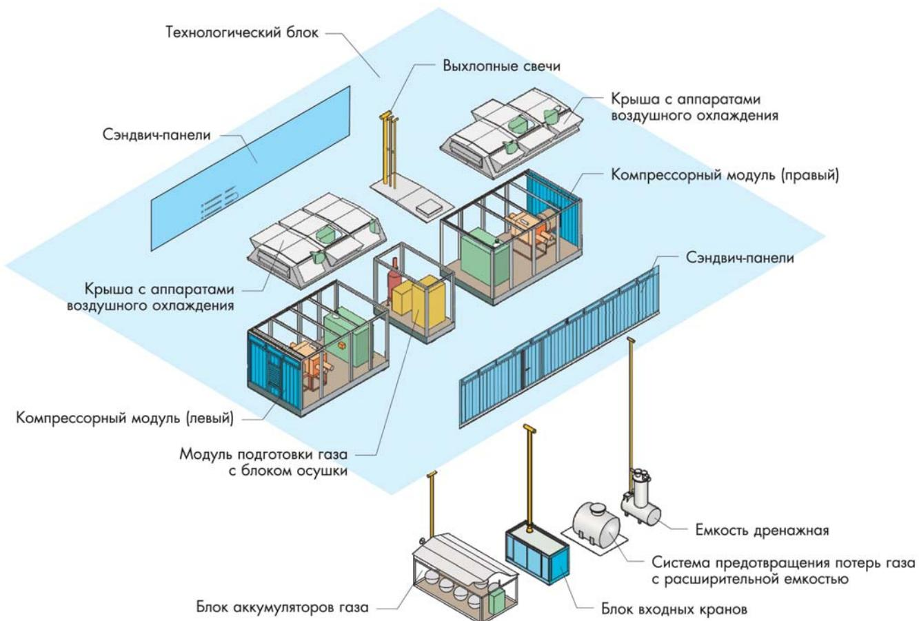
Для расширения функциональных возможностей двухкомпрессорных станций предлагается следующий комплект оборудования:
