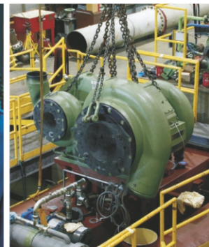
Подготовка к испытаниям по замкнутому контуру компрессора для сжатия окиси углерода
