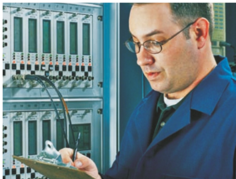
Компьютеризированный пульт управления испытательного центра компании Cameron обеспечивает автоматизированное управление системой охлаждения, скоростью вращения ведущего вала, системой смазки.
