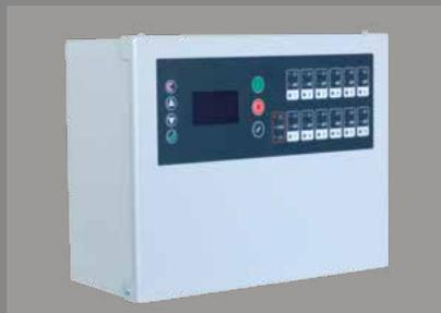
Контроллер XC - наиболее совершенный контроллер для управления компрессорами. Имеет возможность управления до 24-х компрессорных установок, распределенных в различных зонах (до 3-х) единой сложной пневмосети. Позволяет осуществлять запуск дополнительного оборудования, поддерживать дистанционный баланс давления в зонах пневмосети. Имеет 8 цифровых входов, 4 цифровых выхода, 10 релейных выходов, 12 дополнительных блоков ввода-вывода.
