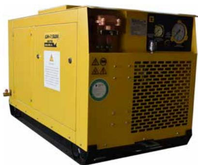
Предназначены для снабжения сжатым воздухом пневматических инструментов, пневматических буровых станков и приводов механизмов в подземных выработках шахт, надшахтных зданиях: не опасных в отношении газа, пара или пыли - исполнение «РН» (рудничное нормальное), а так же опасных в отношении газа, пара или пыли – исполнение «РВ ExdIasI».
