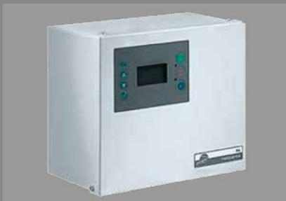
Рассчитан на управление до 4-х компрессорных установок. Позволяет конфигурировать до 3-х различных стратегий управления и контроля величин давления. Дает возможность обеспечить равномерную нагрузку всех компрессорных установок в системе. Имеет функцию «часы реального времени» - возможность точной временной настройки стратегий управления и величин давления.
