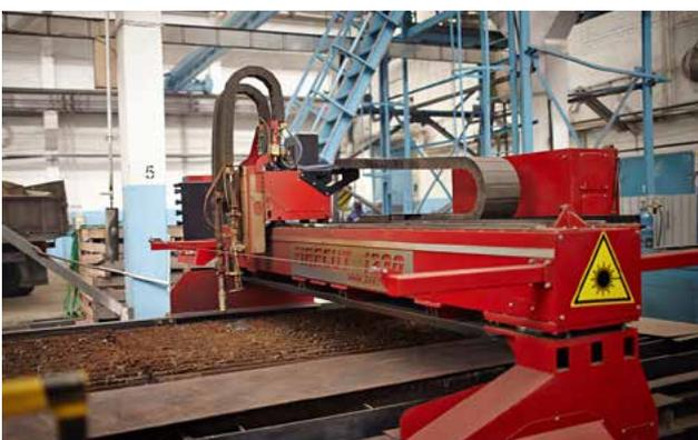
Машина для плазменной резки
