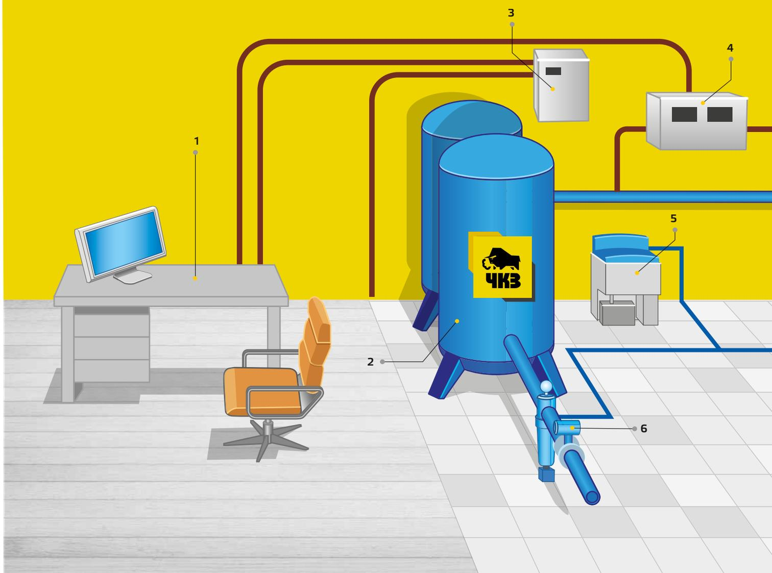
Пример спроектированной «под ключ» компрессорной станции, включающей несколько компрессорных установок, оборудование по подготовке сжатого воздуха, магистральные трубопроводы, систему удаленного управления (на расстоянии до 1000 м и более), устройство контроля за расходом сжатого воздуха, систему отвода горячего воздуха от компрессоров для обогрева производственных помещений, систему обогрева воды бытового назначения и др.
