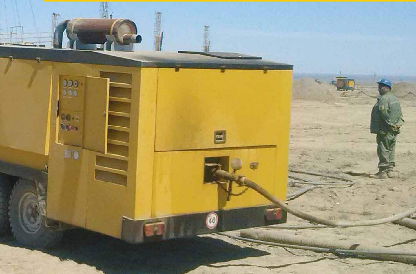
Компрессорные установки типа КВ с приводом от дизельного двигателя представляют собой изделия, работающие по принципу объемного сжатия. Изготавливаются на основе винтовых блоков ведущих производителей и дизельных двигателей фирм ЯМЗ, ММЗ, Deutz, Isuzu, Kubota, Cummins. Смонтированы на собственной раме в звукоизолирующем капоте, не требуют специального фундамента.
