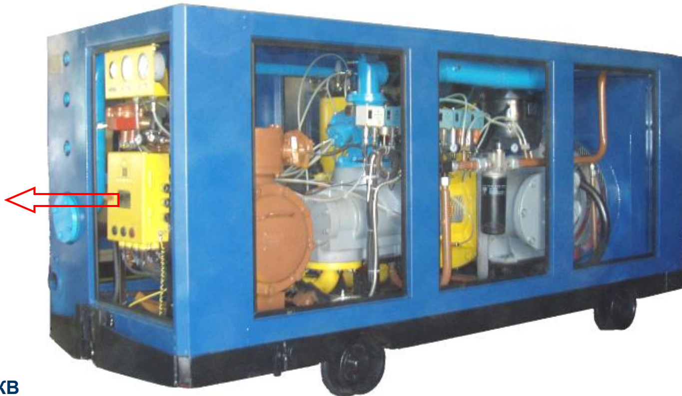
Шахтная винтовая компрессорная установка УКВШ-10/7 А У2 с электрической системой защиты на базе УЗКВ
